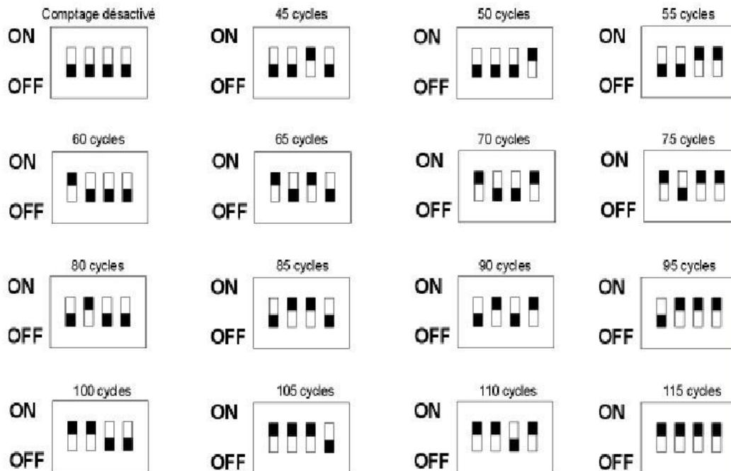
Après avoir réglé les commutateurs DIP, alimenter la machine en courant tout en continuant à presser le bouton A-2.
